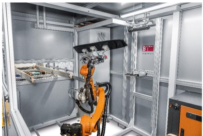
Der Roboter nimmt die Baugruppe dann auf und positioniert sie in die eigentliche Prüfposition. Der zweite 3-D-Scanner stellt die 3-D-Daten für unsere eigens entwickelte virtuelle Kamera dar.
