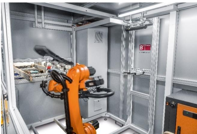
Absolut flexibel: Diese Informationen übermittelt der Scanner im Sekundenbruchteil an einen Roboter. Dieser Roboter ist dadurch in der Lage, die jeweilige Baugruppe schnell und sicher aufzunehmen.
