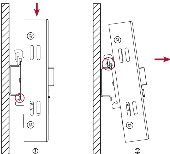
Abb. 17: Gerät demontieren
