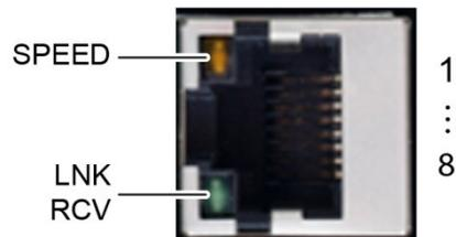
Abb. 4: Ethernet-Schnittstelle X4
