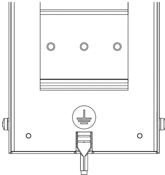
Abb. 6: Anschluss Erde über Kabel mit Flachsteckhülse
