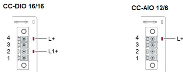
Abb. 4: Energieversorgung Stecker X1 mit Power-LEDs
